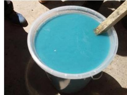
Paso 4. (prueba de acidez-alcalinidad), amarrar los clavos en un extremo de la cuerda, e introducir en la sustancia mezclada durante 1 minuto. Sacar los clavos y si estos presentan manchas de oxido, agregar más cal hidratada hasta conseguir que el hierro no se oxide.
